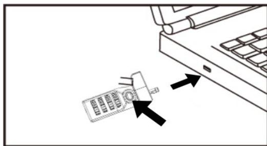
Pulse el interruptor de bloqueo e inserte el candado de combinación en la ranura del portátil.
