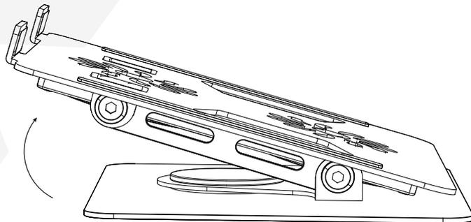
**3** Sujete la base del otro lado con la mano derecha y levante el panel con la mano izquierda para ajustarlo a una altura adecuada.
